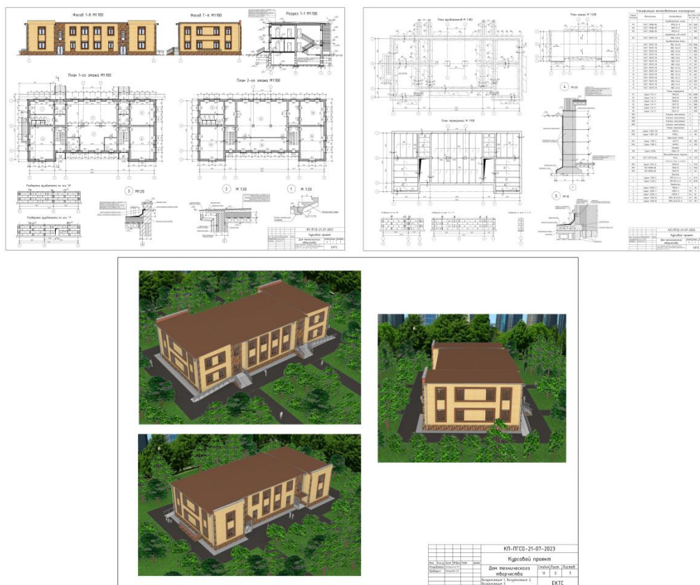
Рис.2 Пример выполнения графической части курсового проекта с использованием BIM-технологий
